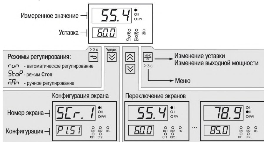
Рисунок 6.5 – Схема переходов с главного экрана
