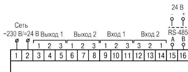
Рисунок 5.7 – Общая схема подключения ТРМ12–Н
